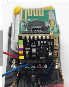
Das grüne Kabel **Rear/Break** wird mit den beiden oberen Pads auf dem CarDecoder verbunden!
