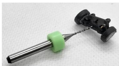
Die Bohrung für den Lenkschleifer muss mit 0,8mm nachgebohrt werden.
