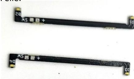
Entfernen Sie auch hier die Bruchkanten mit einer Feile.
