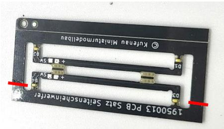
Dazu trennen Sie den Rahmen mit einem Seitenschneider an den rot markierten Stellen auf.
