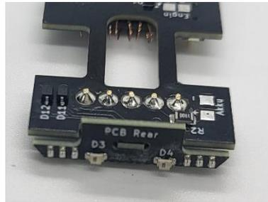
Setzen Sie die Leiterplatte PCB Rear an.
