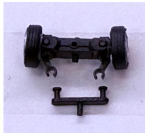
Klipsen Sie die Achsschenkel in den Lenkungsträger.
